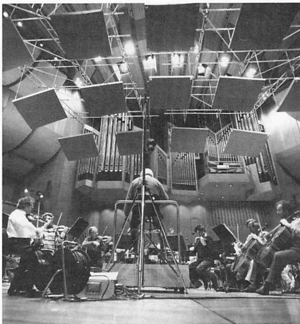
Fast wie „fliegende Untertassen“ wirkten die bei den Tests verwendeten hölzernen Segel
